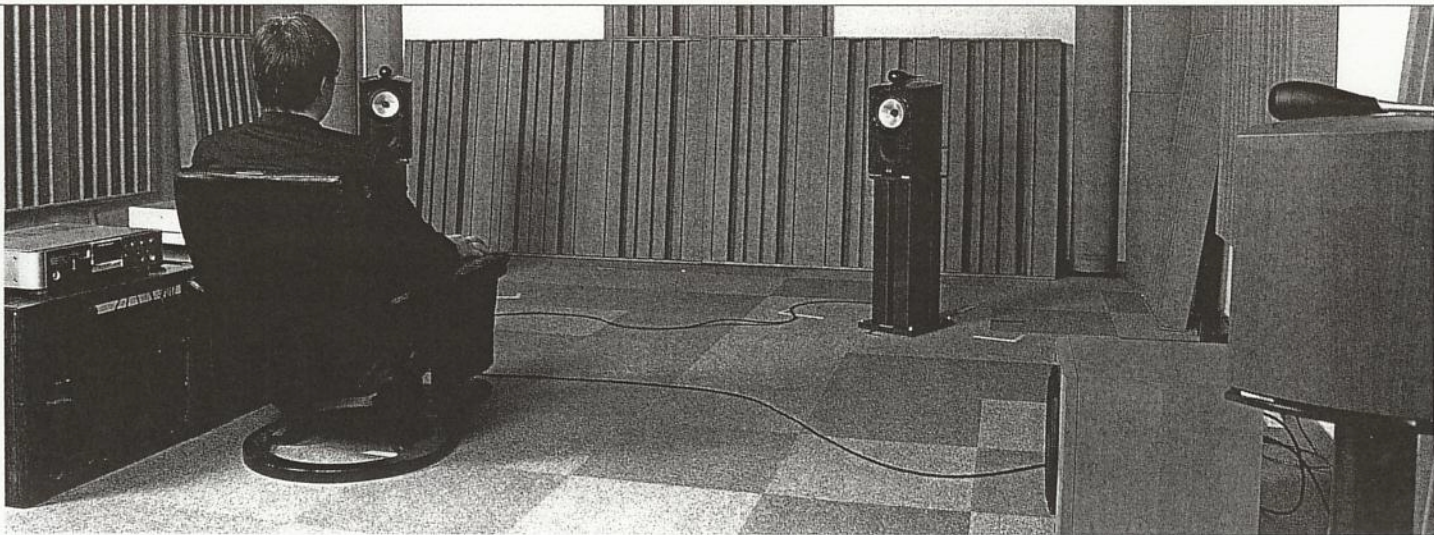
組合せ機器を選択するための試聴をした時の基本セッティング状態。4本のスピーカーはリスニング位置から約220cmの距離でITU-Rの勧告に完全準拠した配置とし、サブウーファーは暫定的に右横にセット。ラックは左横に2台並べ、上段にSACDプレーヤーとプリアンプを並べた。またパワーアンプはラック後方のウッドブロックに設置。各機器へのAC電源供給は、SACDプレーヤーとプリアンプは別系統の壁コンセントから、4台のモノラルパワーアンプはCSEのタップを介して行なっている。
