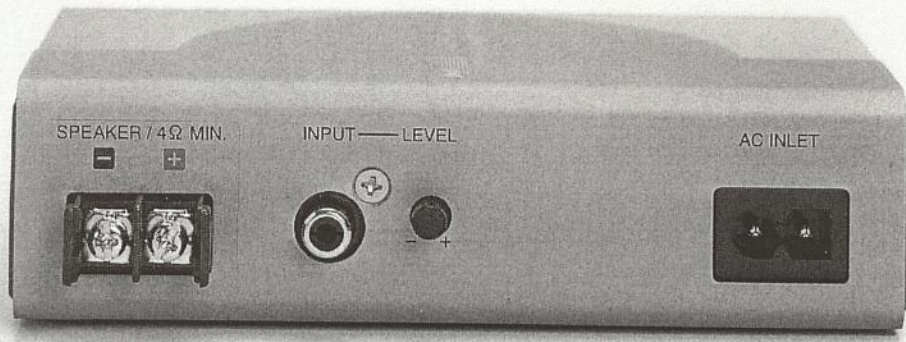
入力1系統とネジ式のSPターミナルだけ。入力可変ボリュームがあるので、CDプレーヤーからの直結も可
