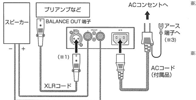
※2 BIタイプのスピーコン出力端子は1+と2+, 1-と2-がそれぞれ内部で並列接続されています。推奨コネクタ: NEUTRIK社製 NL4FXまたは同等品
